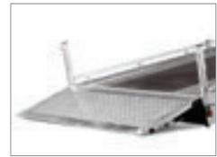
Durch anklippb. Ladefläche und niedrigem Rampenwinkel von 9 Grad gut zu befahren.
